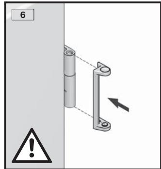
**Bei Einbauten in der Tür ist der Staubschutz erst am Aufstellort zu montieren!**
