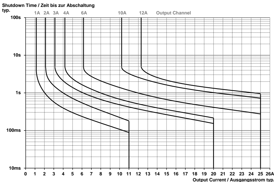
Fig. 5 / Bild 5 Shutdown characteristics for 1A, 2A, 3A, 4A, 6A, 10A and 12A output channels / Auslösekennlinie der 1A, 2A, 3A, 4A, 6A, 10A und 12A Ausgangskanäle
